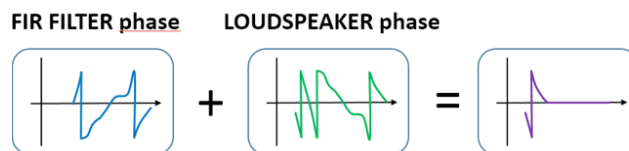
Figur 3 – Summe der Phasenverläufe von FIR-Filter und Lautsprecher.
