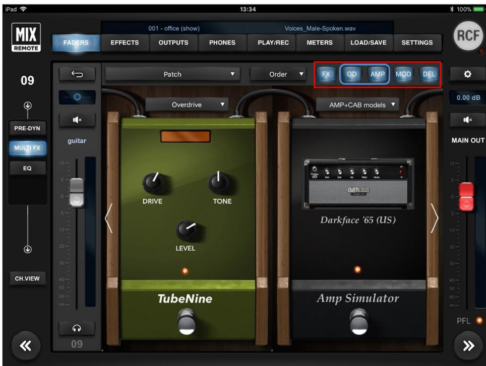
Nella parte superiore di ogni pedale, c'è un display che mostra l'ultimo valore di un controllo modificato. Nella parte inferiore è presente un interruttore di attivazione; il suo stato è visualizzato da una spia che si accende quando l'effetto è attivo. La sezione **OD** consente di scegliere tra un effetto **Overdrive** o **Distortion**, modellato su noti effetti a pedale utilizzati da decenni dai chitarristi.
