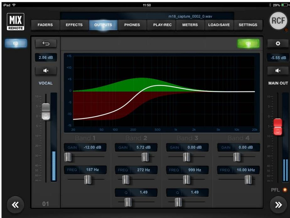
Esempio: dopo aver premuto il tasto \* della mandata AUX 1, si apre la rispettiva pagina dell'equalizzatore a 4 bande: shelving basso (40Hz-400Hz) e alto (1kHz-16kHz) e due bande completamente parametriche (range 100Hz-10kHz per entrambe).
