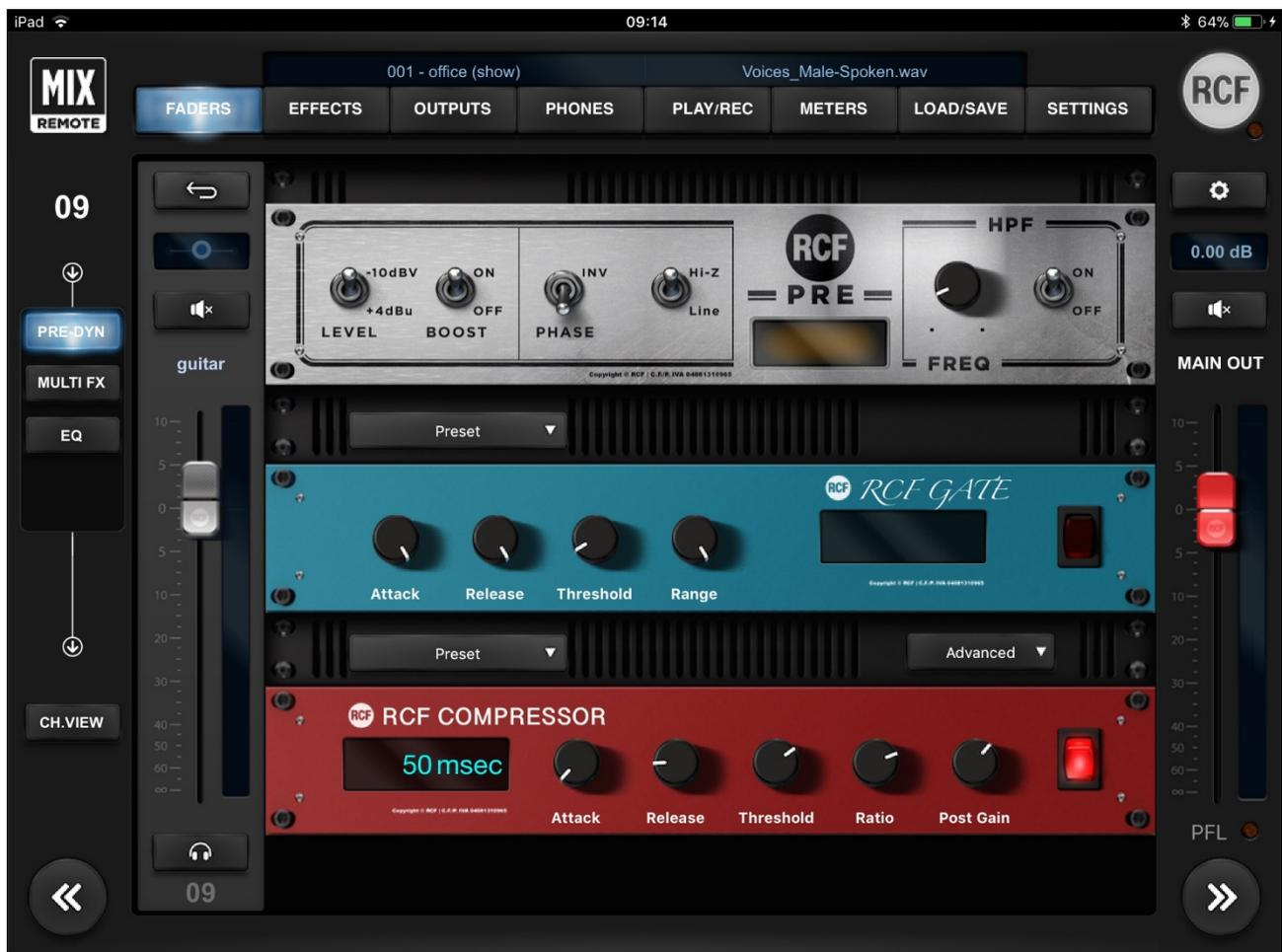
È possibile impostare il livello d'ingresso **LINE** tra **-10dBV** e **+4dBu**; l'opzione **BOOST** (quando attiva ON) comporta un ulteriore incremento di 2 dB. L'opzione **Hi-Z** predispose l'ingresso ad alta impedenza per l'uso diretto di chitarre o bassi passivi; in modalità Hi-Z, l'impedenza è 1 MΩ. Quando si utilizzano strumenti musicali attivi, si consiglia di mantenere l'opzione **Hi-Z** su OFF.
