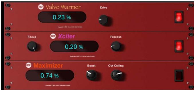
Questi tre processori sono stati sviluppati in modo da funzionare insieme od individualmente, per ottenere un suono più caldo e ad un livello più alto. È possibile bypassare ogni processore con il rispettivo interruttore sulla destra (per facilitare la valutazione del suo effetto nel mix complessivo).
