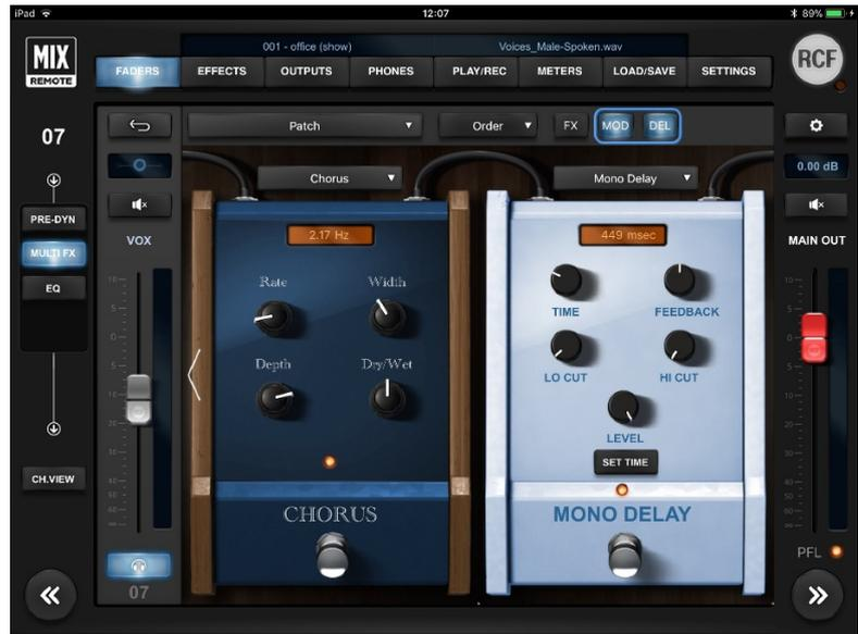
Nella parte superiore di ogni "pedale", si trova un display che mostra l'ultimo valore di controllo modificato. In basso c'è l'interruttore per l'attivazione (indicata da una spia accesa).
