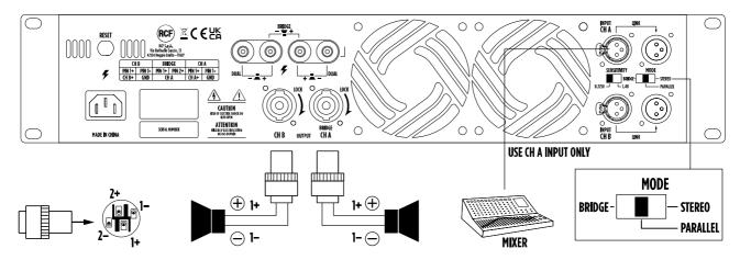
ATTENZIONE: SPEGNERE L'AMPLIFICATORE PRIMA DI CAMBIARE IL MODO DI FUNZIONAMENTO!
