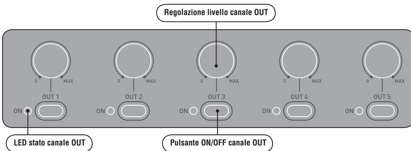
La sezione di uscita è analoga a quella di ingresso, tranne che non comprende il led di segnalazione livello. Per ogni canale è presente un potenziometro che regola il livello del segnale, ed un pulsante che abilita/disabilita l'uscita.
