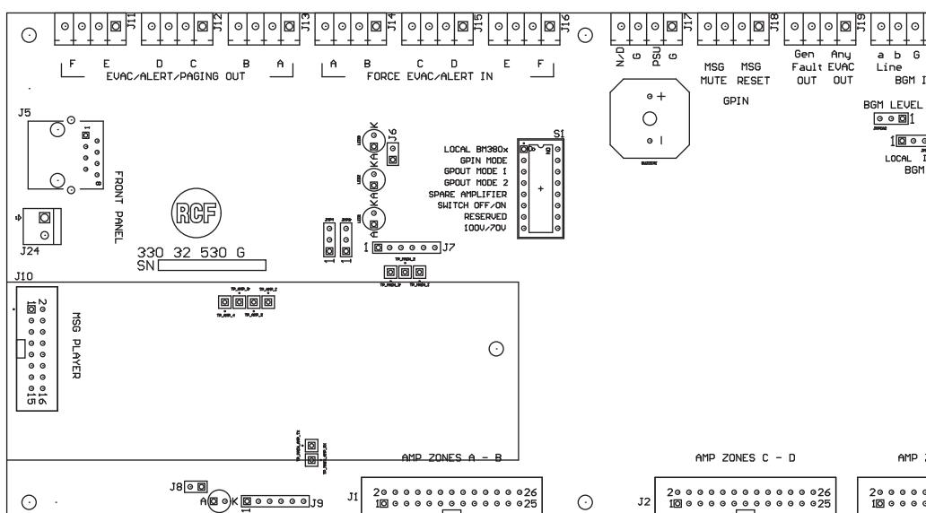
IE 3008 è una scheda opzionale che si installa all'interno delle unità centrali MX 3250 e MX 3500 (sistema DXT 3000) e permette di collegare insieme fino a 8 unità.
